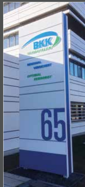
BKK, Kirchheim unter Teck Pylon mit dekupierter Frontplatte, durchgesteckten Acrylbuchstaben und Konturbeleuchtung
