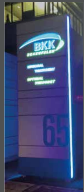
BKK, Kirchheim unter Teck Pylon mit dekupierter Frontplatte, durchgesteckten Acrylbuchstaben und Konturbeleuchtung
